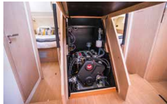
Kıç kamaralar arasındaki çıkarılabilir paneller jeneratöre ayrılmış geniş bir mekanik alana giriş için rahat bir erişim imkânı sağlıyor.
